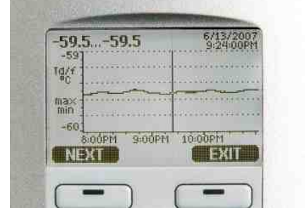
显示屏可显示测量曲线、实时数据以及历史数据。
